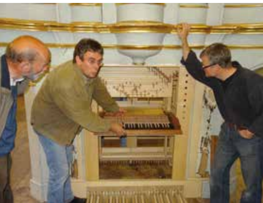
Orgelbauer Müller und Bükki erklären die Transponiereinrichtung.
